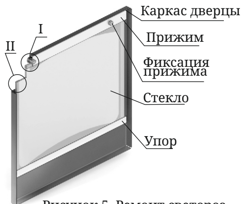
Рисунок 5. Ремонт светопрозрачного экрана дверцы
