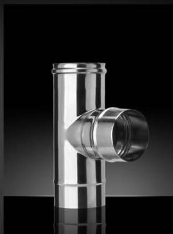
Для обеспечения герметичности тройников, которые ранее производились из двух труб с фасонными вырезами и сваркой встык, была внедрена в производство новая технология – холодная вытяжка кромки фасонного отверстия основной трубы тройника. К образующейся после вытяжки цилиндрической отбортовки приваривается боковая труба на станке контактной сварки. Таким образом, было получено изделие по принципиально новой технологии с герметичным сварным швом.
