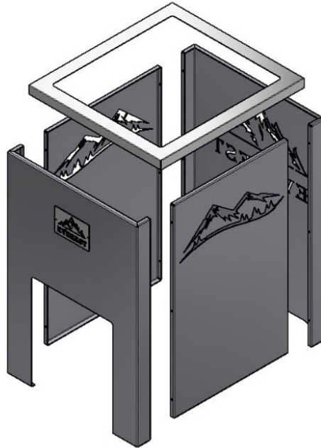
Рис. 2 Схема сборки кожуха конвектора
