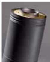
Внешний контур покрашен экологически безопасной краской черного или серого цвета, имеющей повышенную стойкость против царапин. Внешний контур вставляется один в другой, и не требует использования хомутов и фиксаторов. Диаметр внешнего контура изолированных модулей дымохода составляет 280 мм, полуизолированных модулей - 226 мм.
