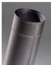
Изготовлен из нержавеющей стали толщиной 0,8 мм и имеет внутренний диаметр 150 мм. Снизу внутренний контур имеет зигование, гарантирующее сохранение круглой формы и нужное расстояние до изоляции, и предотвращающее утечки воздуха.
