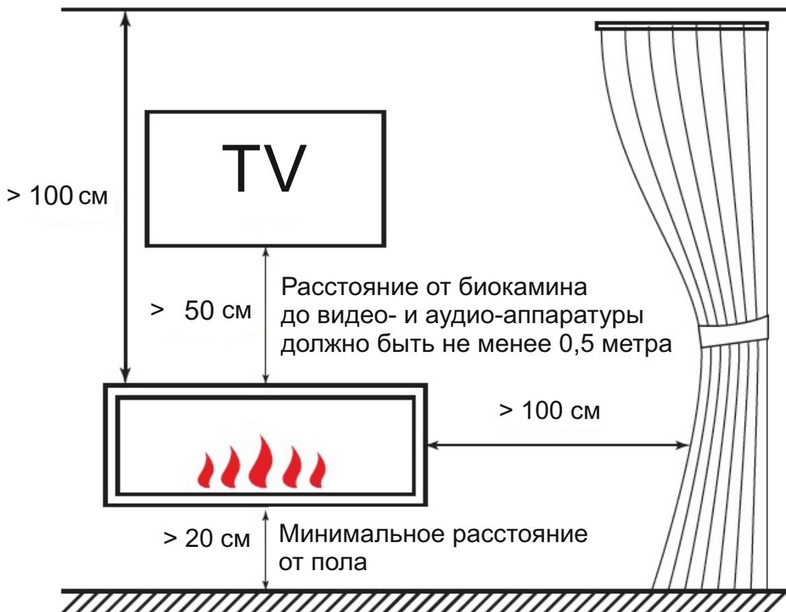
Подготовленная в стене ниша должна быть зготовлена из негорючих материалов: гипсокартон, кирпич, бетон, пеноблоки.
