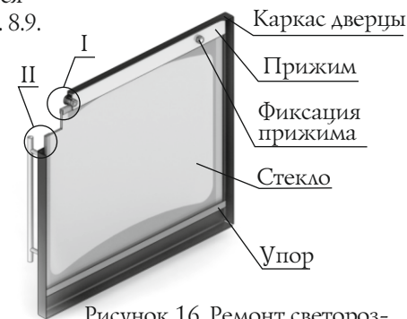
Рисунок 16. Ремонт светорозрачного экрана двери модели «Витра»
