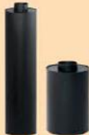
Труба защитная в сборе (сэндвич) d = 245 × 1,0 мм / 114 × 3,0 мм L = 1000, 500 мм Материал – сталь ст3пс/08пс, минвата
