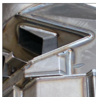
Cámara de combustión de acero.
