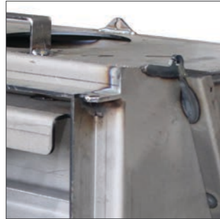
Cámara de combustión de acero.
