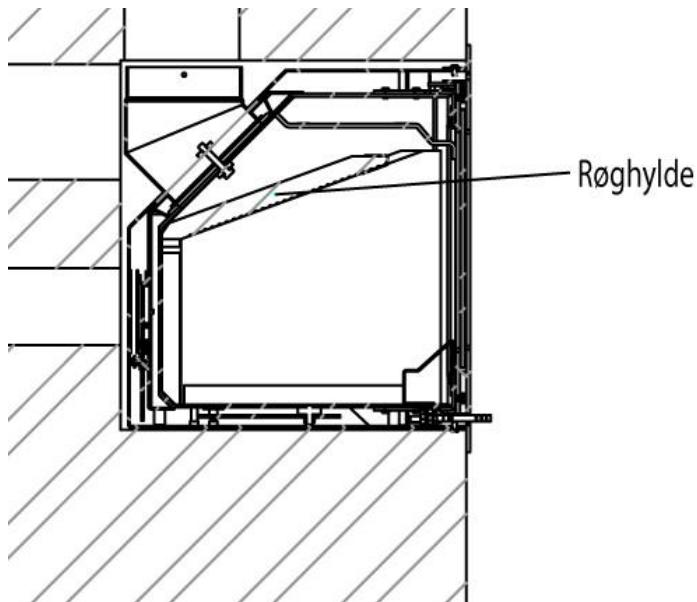
Дефлектор убирается путем подъема с одной стороны, после чего он освобождается с другой стороны и попадает в камеру сгорания и вынимается через дверь. Точно так же он ставится на место, перемещаясь вверх под углом с одной стороны и затем с другой стороны, и тогда он будет помещен на место в середине.
