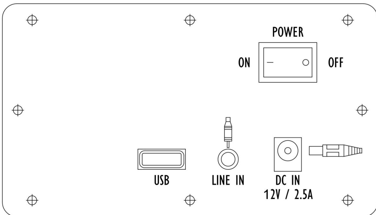
1. Вставьте штепсельную вилку постоянного тока в 12В/2. 5А на задней панели, а затем надежно вставьте вилку шнура питания AC100-240В в розетку линии электропитания.
