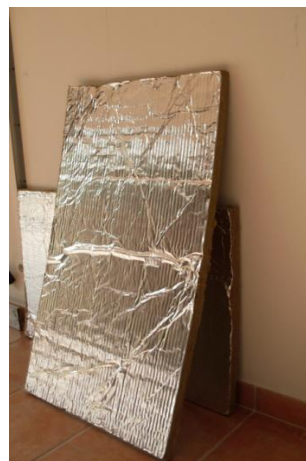
Изоляционный материал толщиной 3 см + алюминиевый лист
